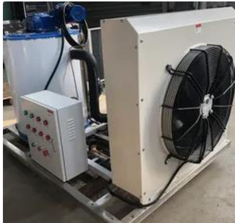
Figure 43. Exemple d'une machine à glaçons montée sur le toit pour une salle de glaçons
